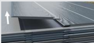
Hardie® VL Plank brædder leveres stukket ind i hinanden. Facadebrædderne skal derfor først trækkes ud sideværts, før de må løftes af pallen.
