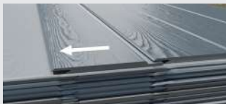
Hardie® VL Plank brædder leveres stukket ind i hinanden. Facadebrædderne skal derfor først trækkes ud sideværts, før de må løftes af pallen.
