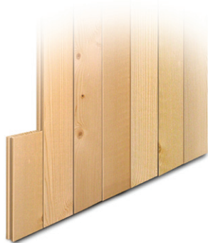
EI 30. Väg av min. 50 mm spontad träpanel eller 24 mm*) Byggelits spontade spånskivor.
