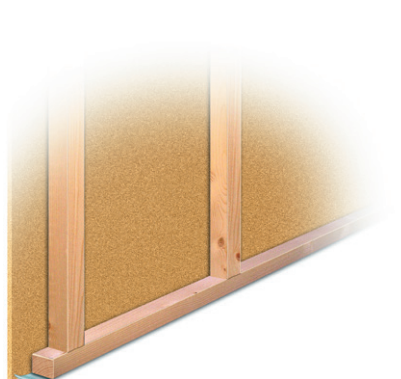
EI 15. Väggar med stomme av träreglar min. 45x45 mm c ≤600 mm, på en sida försedd med min. Byggelits 12 mm spånskivor.
