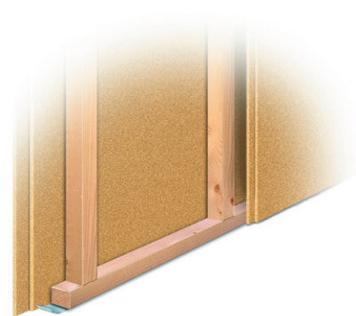
R 30. Väggar med stomme av träreglar min. 45x70 mm, c ≤600 mm, på båda sidor försedd med min. Byggelits 24 mm*) spånskivor.
