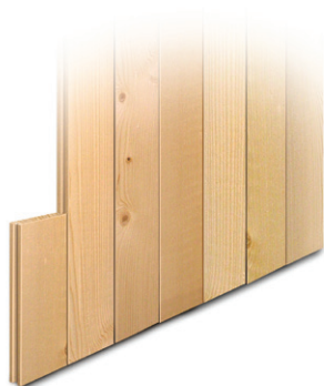
EI 30. Vegg av min. 50 mm spontad träpanel eller 24 mm*) Byggelits spontade spånskivor.
