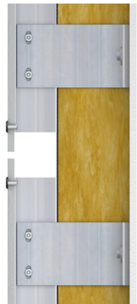
Profilstød = åbent pladestød/pladesamling
